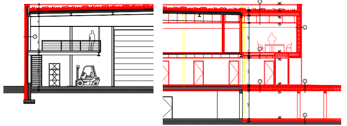
Coupe constructive sur hall des véhicules 1/50
